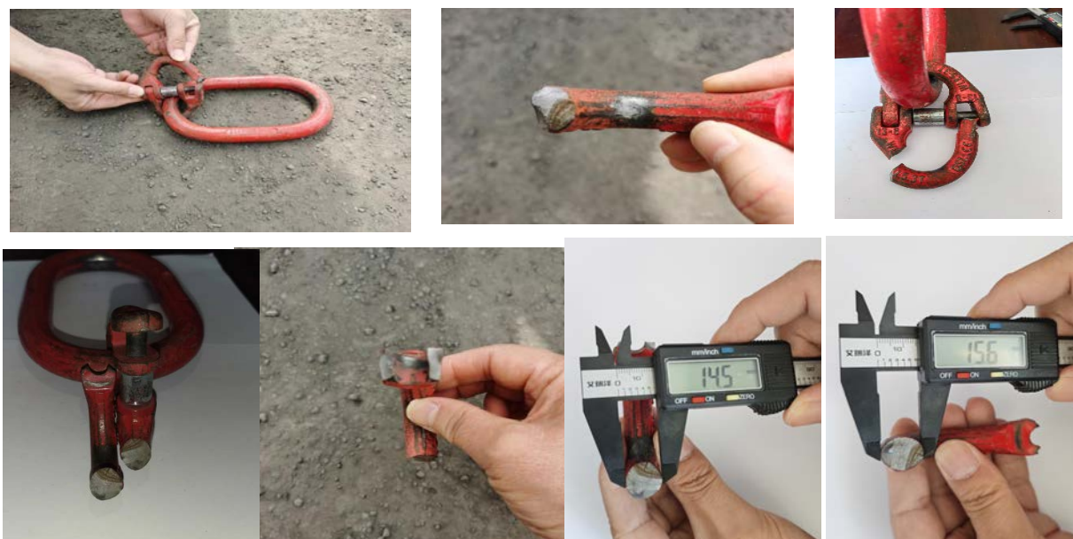
图9 东侧吊链断裂的欧式双环扣
